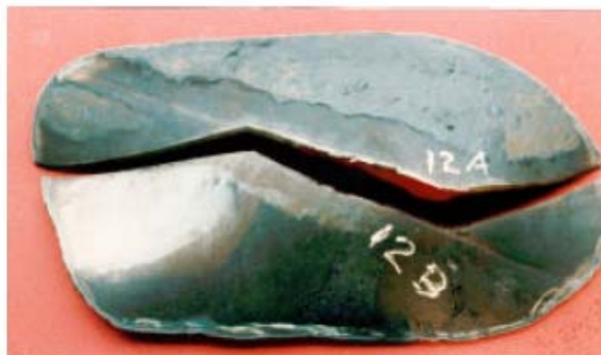
شکل ۳- عیب چروک شدن gouge
